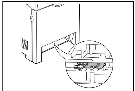
4. 將送紙輪鉤從軸的凹口拉出，然後將送紙輪滑動至左邊。
