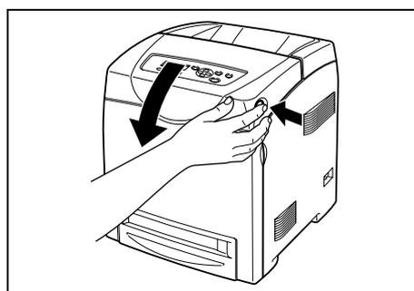
4. 抓住油輪組件的凸起並完全打開組件。
