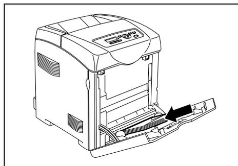
2. 將紙張調整桿滑動至信封的尺寸。
