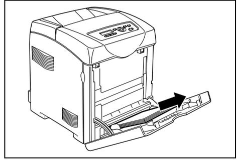
5. 將紙盤從機器中拉出並取出紙盤中的紙張。將紙張包起，防止潮濕和灰塵。
