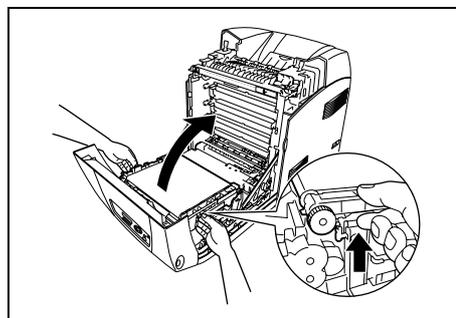
5. 用雙手抓住油輪組件的兩側，拉組件的右側直到右側的凸起從凹槽出來。然後將油輪組件移右邊，將組件從印表機上拆下。
