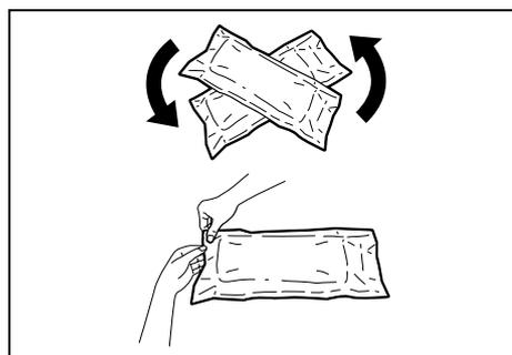
5. 拉列印卡匣末端的標籤，撕下碳粉封條。
