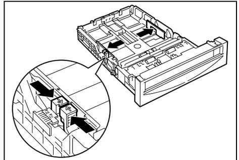
3. 輕輕地向裏按紙盤後部的杆，擴大紙盤以適合紙張尺寸。
