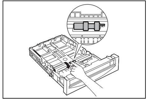
5. 將送紙輪鉤從軸的凹口拉出，然後將送紙輪滑動至右邊。
