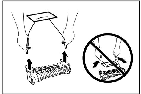
8. 熔著部的連接器對著插槽，降低熔著部的位置然後將連接器牢固推入插槽。
