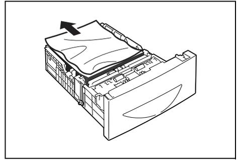
3. 小心翼翼地拉出夾紙，以免撕破。如果紙撕破，請取出印表機內的所有殘留的紙片。
