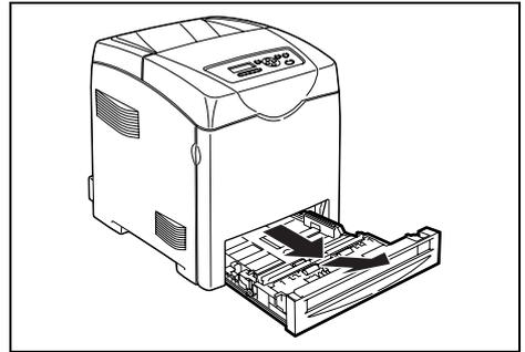
2. 將寬度紙張調整桿滑動至紙盤邊緣。寬度紙張調整桿需完全展開。
