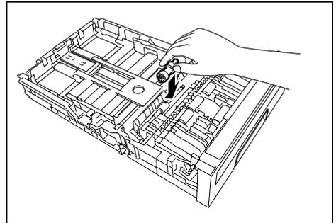
7. 沿著軸滑動送紙輪，使突起與軸上的插槽完全吻合。
